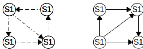
Fig 15: Deux graphes orientés, un fortement connexe (trait pointillé) et l'autre non fortement connexe (trait plein). Le graphe non fortement connexe possède quatre composantes fortement connexes : les sous-graphes possédant un seul sommet.
